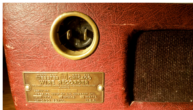
Abbildung 4: Netzanschluß ohne Schutzleiter
